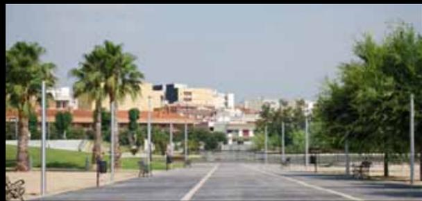
Los paseos que comunican el anillo central del parque y los diferentes caminos, se consideran zonas poco transitadas y con el objetivo de conseguir un ahorro energético adecuado se ha fijado una clase de alumbrado S4 ( $E_m=5\text{lux}$ ,  $E_{mín}=1\text{lux}$ ), proporcionando una leve iluminación, pero suficiente, que sirva de guía óptica en su recorrido y de hilo conductor al estanque central.
