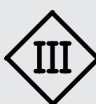
Classe III. Apparecchio in cui la protezione contro la scossa elettrica si basa sull'alimentazione a bassissima tensione di sicurezza (SELV) ed in cui non si producono tensioni superiori alla stessa/ Class III: A luminaire in which protection against electric shock relies on supply at safety extra-low voltage (SELV) and in which voltages higher than those of SELV are not generated
