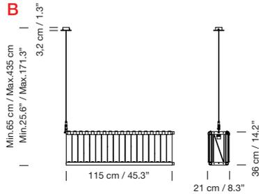
Estructura metálica negra con pantalla de vidrio de pavés.
