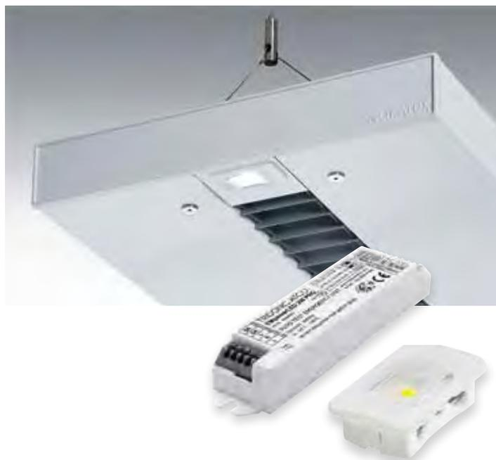
En funcionamiento normal, con la versión PRO puede regularse la intensidad entre el 100 % y el 10 %. En modo de luz de emergencia, la potencia de la luminaria LED se baja a cerca de 1 W, alimentándose con baterías de NiMH con una capacidad de dos amperios hora. El período de operación es, a elección, de una, dos o tres horas. Los EM powerLED se ofrecen en los modelos con autoprueba (ST) y PRO.
